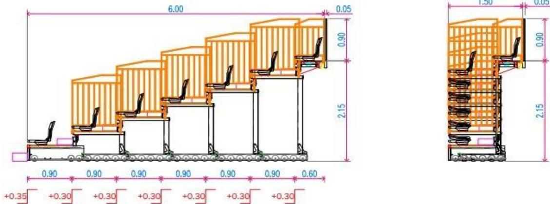
LAS GRADERÍAS DEBERÁN SER ELEVABLES PARA PODER SER TRANSPORTADAS A CUALQUIER PUNTO DENTRO DEL RECINTO POR MEDIO DE UN FORKLIFT (MONTACARGA MANUAL EL CUAL DEBE ESTAR INCLUIDO UNO PARA CADA GRADA) DE ESTA MANERA LOS SISTEMAS FUNCIONARÁN EN LA POSICIÓN DESEADA SEGÚN EL TIPO DE EVENTO A DESARROLLAR:
