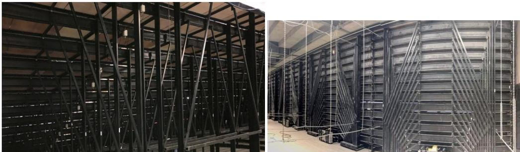
D. **GUÍAS BAJAS DE PISTA:** consiste en una barra externa para un deslizamiento que asegure la coordinación entre los soportes verticales, además de permitir un movimiento suave y uniforme.
